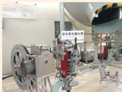
蒸気発生器細管検査訓練設備
